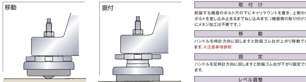
※注意事項 特にボールタイプのものについては位置決め、微調整程度の移動を前提としていますが、支持点重量と床の状態によっては動かない場合もあります。その場合はテコを使って動かす様にして下さい。但し、床に傷のつくことが予想される場合には他の移動手段を考えて下さい。
